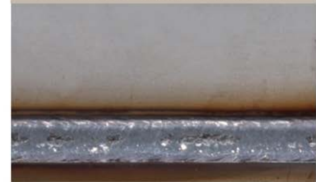
1.4301(304), t=10 mm, assemblage en T, soudure en angle sans préparation du cordon, I = 324 A, U = 25,6 V, dévidage = 11,5 m/min, Vs = 35 cm/min
