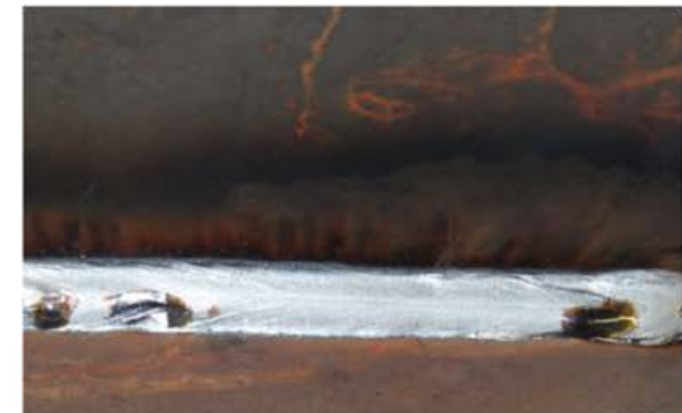
S355, t=10 mm, assemblage en T, soudure en angle sans préparation du cordon, I = 316 A, U = 28,8 V, dévidage = 10,5 m/min, Vs = 50 cm/min
