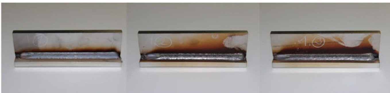
Figure 7 : Comparaison de l'aspect des cordons et des colorations thermiques, tôle t = 10 mm, DV = 13 m/min ; à gauche forceArc puls, au centre forceArc, à droite arc pulsé
